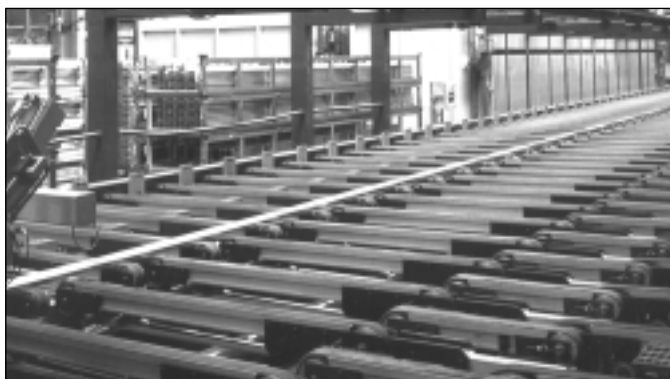
Figura 7b - Particolare della zona trasferimento profilati in un impianto di estrusione. (foto Omav)
