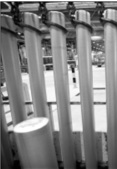
Figura 6 - Billette da estrusione all'uscita del pozzo di colata. (foto Hydro)
