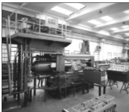
Figura 2a - Pressa da estrusione da 600 tonnellate. (foto Prima)
