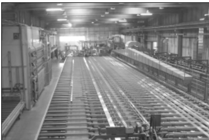
Figura 7a - Profili estrusi in uscita dalla pressa. (foto Estral)
