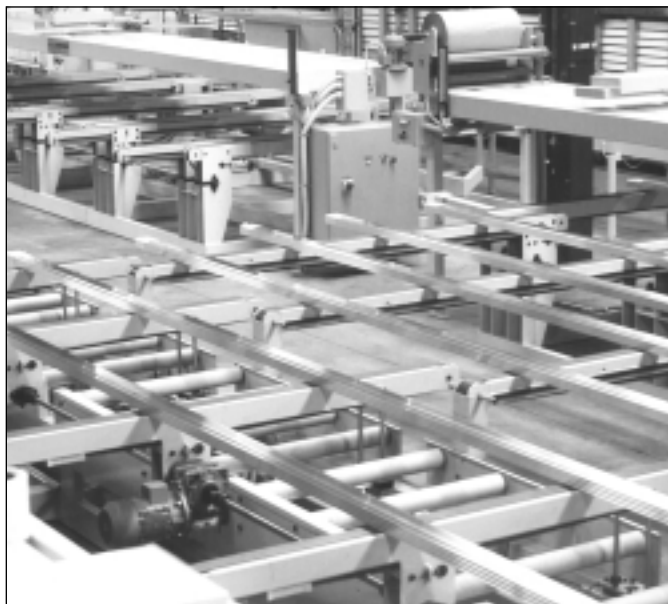
Figura 8 - Particolare della zona imballo profilati in un impianto di estrusione. (foto Emmebi)
